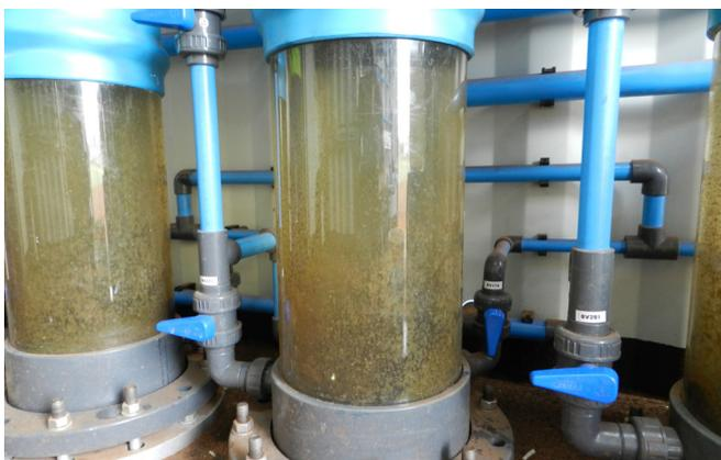
Koagulations- und Flockungssäulen zur Klärung des Flusswassers. © Fraunhofer IST | Bild in Farbe und Druckqualität: [www.fraunhofer.de/presse](http://www.fraunhofer.de/presse).
